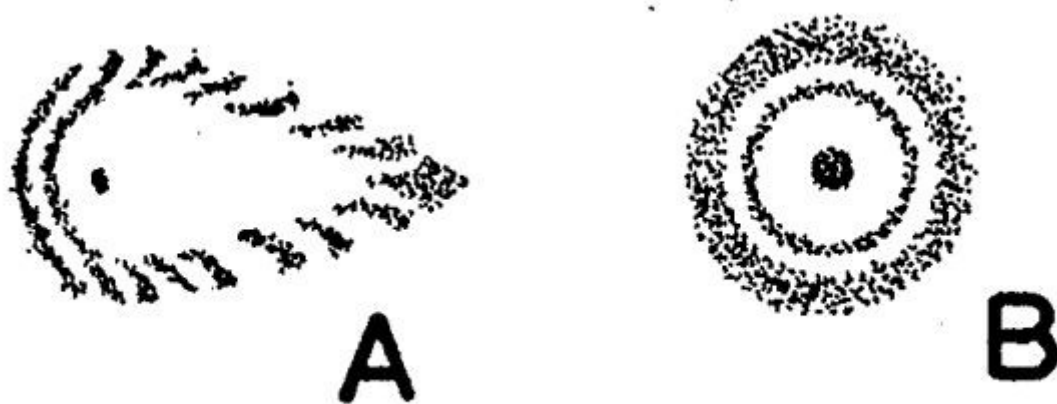
Obr. 5: ohybové kroužky rozostřeného obrazu hvězdy při vycentrovaném (A) a nevycentrovaném (B) objektivu dalekohledu
