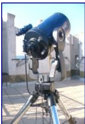
Obr. 2: Elektronicky řízený dalekohled LX200 GPS Meade (průměr objektivu 12" - přibližně 0,3m). cena cca 95.000,-
