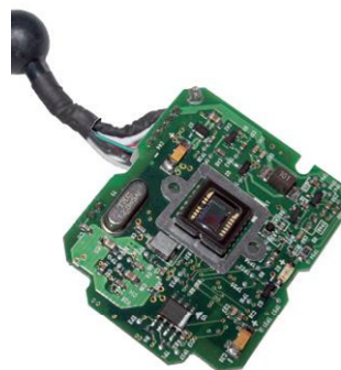
Elektronika kamery zbavená krytu a objektivu
