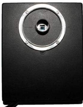
Kamera v nové krabičce se závitem M 42 × 1
